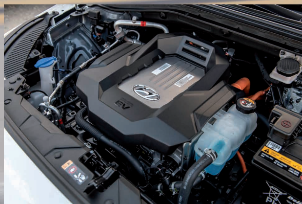
Pohonné jednotky IONIQ Hybrid: 1,6 l GDI + 32 kW IONIQ Plug-in Hybrid: 1,6 l GDI + 45 kW IONIQ Electric: 38,3 kWh, 134 koní.
