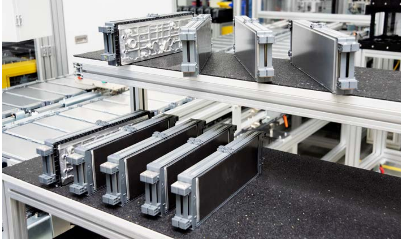
Základní díl, tzv. BMA modul, se skládá buď ze dvou bateriových článků pro slabší verzi baterie, nebo ze tří bateriových článků pro silnější baterii.
