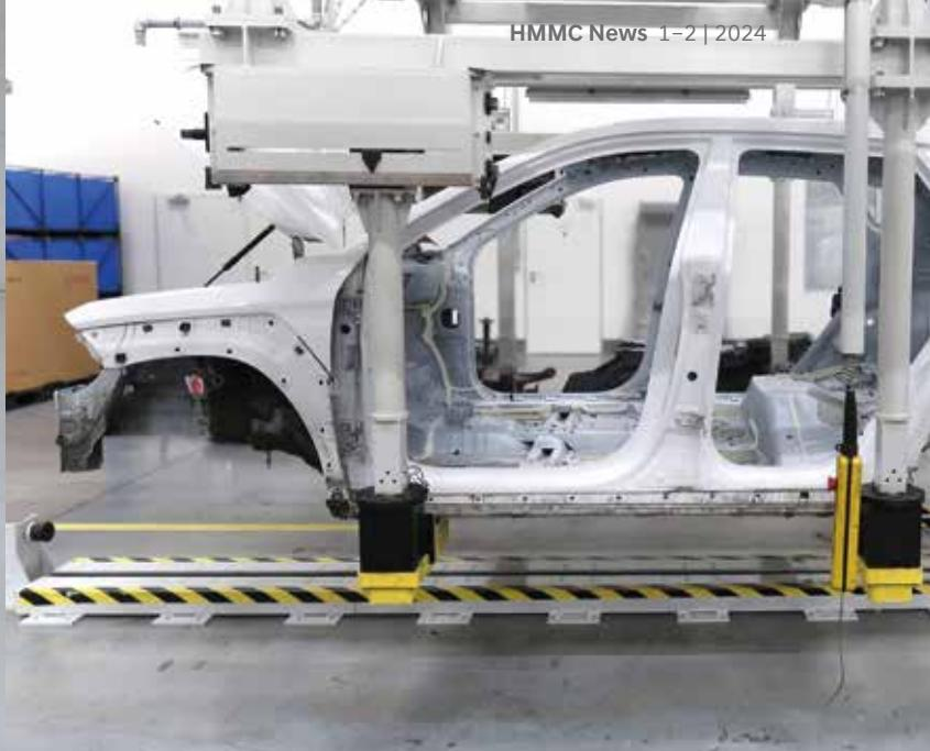
**V**hale Finální montáže HMMC, kde se (nejen) Kona Electric kompletuje, zažil testovaný vůz po měsících intenzivních jízd přesný opak. „Auto rozebereme na holou karoserii a díly téměř až na prvočinitele. Tohle je první část, kdy ohledáme vozidlo. Soustředíme se na korozi a opotřebení jednotlivých dílů. Následně naše nálezy ukážeme managementu,“ popisuje u rozebraného vozidla Petr Jirotka, vedoucí sekce AQD (Pokročilý vývoj kvality) spadající pod Oddělení kontroly kvality.
