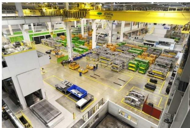
Výrobní proces automobilu začíná v Lisovně. Vstupním materiálem je ocelový pozinkovaný plech o tloušťce 0,7 mm, který je nejprve v dělicí lince nastříhán na tzv. přístříhy. Ty dále putují do jednoho ze dvou obrovských lisů, každý o síle 5.400 tun. Zde probíhá za pomoci dvoudílných lisovacích forem, ve čtyřech krocích, lisování 17 velkých karosářských dílů (blatníky, bočnice, přední a zadní dveře, střecha, kapota, páté dveře). Každý díl je zkontrolován a uložen automa-
