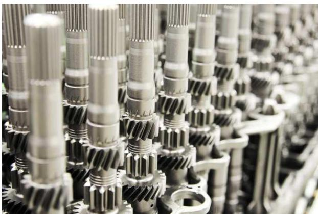
Ocelové polotovary, budoucí ozubená kola a hřídele, jsou obráběny na desítkách přesných strojů, stejně jako hliníkové odlitky převodkových skříní. Opracované součásti ozubených převodů se následně zahřívají na téměř 900 °C a chladí ve speciální soli. Tím ocel ztvrdne a stane se mnohem odolnější.
