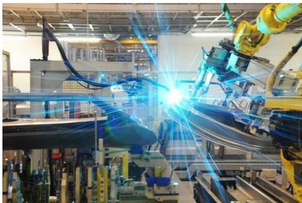
Hala svařovny je plně automatizovaná. Více než 300 robotů si jednotlivé vylisované díly odebírá, kompletuje a svařuje k sobě. Nejprve se sestaví přední část podvozku, pak se montují platformy a bočnice. Tyto díly se spolu se střechou setkají v jedinečném svařovacím zařízení zvaném Main Buck, které umožňuje bez jakéhokoliv přestavování svařovat až 4 různé typy karoserií současně. O důkladné provaření svarů se starají
