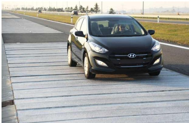
Proškolení řidiči každé auto překontrolují během jízdy na zkušební dráze o délce 3,3 km, kde otestují řízení, ABS, chování vozu na nerovném terénu, kvalitu zvukového systému a řadu dalších položek. Vozidlo je po dokončení všech testů naloženo na kamion nebo nákladní vlak a transportováno k některému z dealerů Hyundai z 56 destinací světa.
