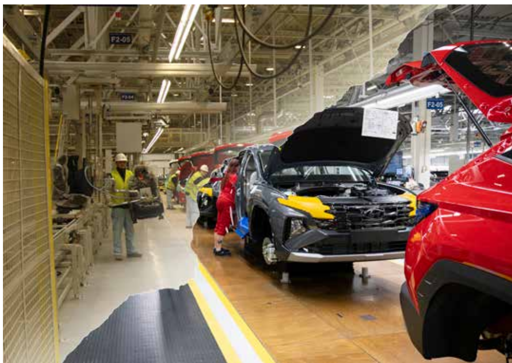
Finální montáž - instalace autosedaček
